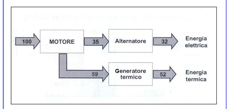
**Generalita'**: Gli impianti di cogenerazione permettono la migliore utilizzazione dell'energia di un combustibile raggiungendo un rendimento dell' 85 % come indicato sullo schema di bilancio energetico sopra riportato.
